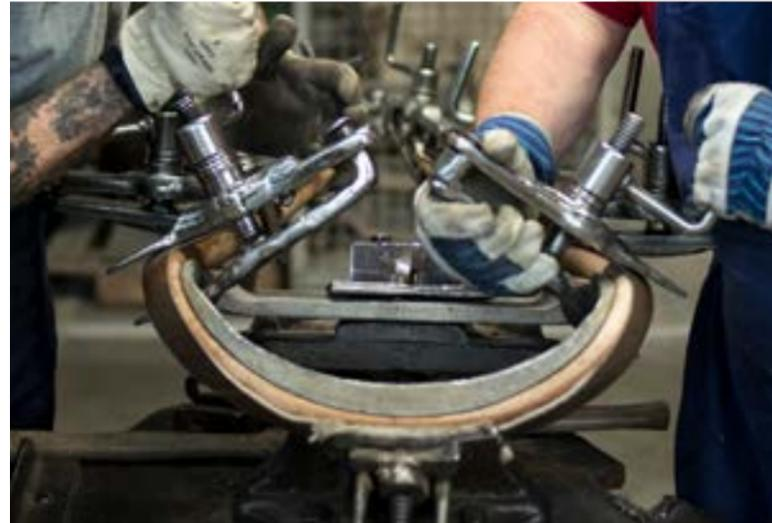
Das Biegen von Holz erfordert Zeit: Über mehrere Stunden bleibt das natürliche Material im Dampfkessel, bevor es in einer speziellen Biegeform fixiert und getrocknet wird. „Das Holz muss ich beim Biegen spüren“, bestätigt Armin Ludwig, der in 34 Berufsjahren in Frankenberg Tausenden von Thonet's Bugholzstühlen ihre unverwechselbare Form verpasst hat.
